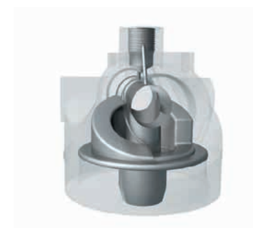
Fluxo positivamente direcionado em um caminho semelhante ao de um ciclone
